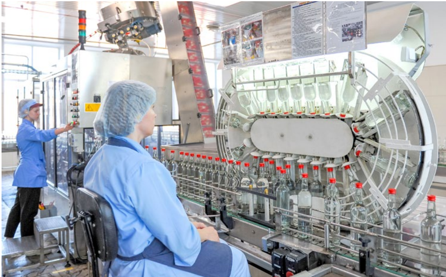
На странице слева: высокоскоростной этикетировочно-маркировочный комплекс от фирмы P.E.
