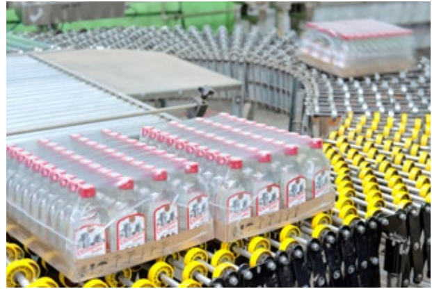
Транспортировочное устройство линии розлива алкогольной продукции цеха №1
